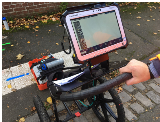
Georadar Utilty scan DF de la marque GSSI
